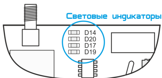
Рисунок 2.1. Расположение информационных светодиодов на плате.
